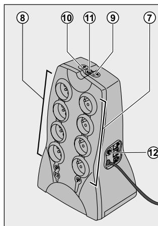
► **Charge batterie :** l'**ASI** charge sa batterie dès qu'elle est connectée au réseau électrique quel que soit l'état du bouton (11). A la première utilisation, la batterie ne donne sa pleine autonomie qu'après une recharge de 8 heures. Pour conserver la meilleure autonomie, il est conseillé de laisser l'**ASI** branchée en permanence sur le réseau électrique.
